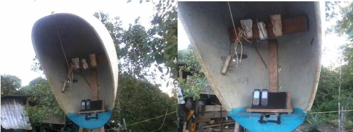
Figura 1: Telefone público improvisado por moradores de uma comunidade ribeirinha próxima a Manaus – AM, com aparelhos celulares ligados à uma antena. No local não há sinal de celular nem telefonia fixa.
